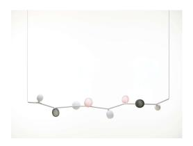
Tech. description Hlavní část svítidla je duralová konstrukce se skleněnými stínítky osazená paticemi G4. Konstrukce se připojuje k přívodnímu kabelu pomocí integrovaného Brokis konektoru a na protilehlé straně je zavěšena na ocelovém lanku. Přívodní kabel je zavěšen na stropním baldachýnu který obsahuje elektroniku.
