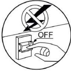
Togliere la corrente dalla rete. Effettuare il fissaggio della montatura dell'apparecchio con idonei tasselli e viti, controllando che i cavi di alimentazione uscenti non vengano deteriorati durante il montaggio. Montare secondo la sequenza indicata nel disegno. Pulizia - Pulire solo con panno inumidito con acqua. Smontare, lavare e rimontare i vetri solamente a interruttore spento
